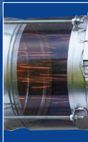
↑ Sichtbare Funken beim Eintritt in den Funkenabscheider (vergrößerte Darstellung unten)
